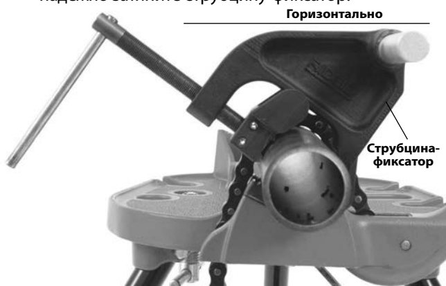
Рис. 11А – Расположение струбцины-фиксатора
