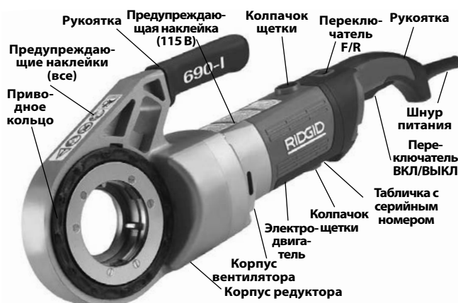
Рис. 2 – Силовой привод модели 690-I
