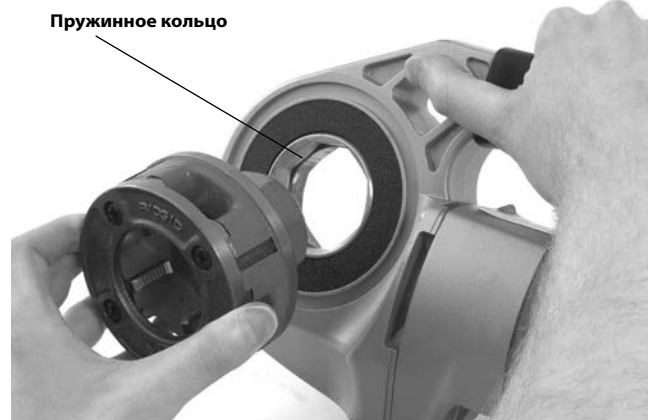
Рис. 9 – Установка резьбонарезных головок в силовой привод 600-I
