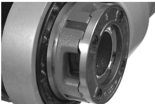
Рис. 15 – Торец трубы вровень с кромкой резьбонарезных гребенок
