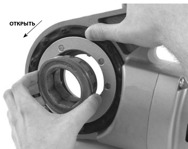
Рис. 8 – Установка переходника в силовой привод 690-I
