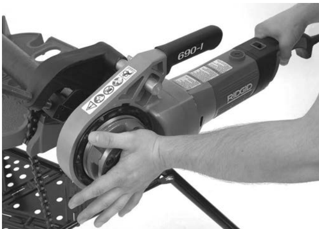
Рис. 13 – Начало нарезания резьбы
