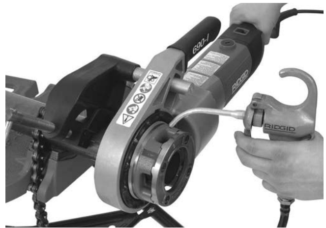
Рис. 14 – Нарезание резьбы на трубе
